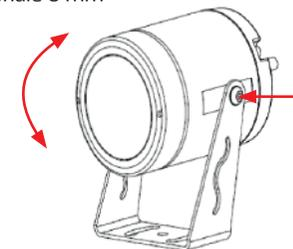
In caso di fissaggio su terreno utilizzare l'accessorio **picchetto** (CEAZZZO17) in acciaio inox e vincolare la staffa tramite vite.
