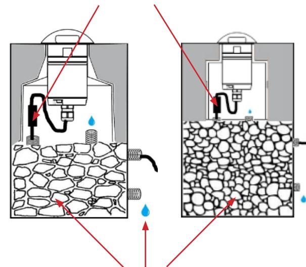
Il fondo della cassaforma deve essere a contatto con materiale drenante per non permettere ristagno d'acqua per lunghi periodi e agevolarne lo scarico tramite condotti.
